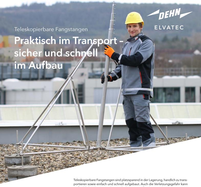
Teleskopierbare Fangstangen sind platzsparend in der Lagerung, handlich zu transportieren sowie einfach und schnell aufgebaut. Auch die Verletzungsgefahr kann maßgeblich reduziert werden mit der kürzeren Aufbaulänge und integrierten Rasttechnik: Kürzere Fangstangen minimieren beim Einlegen das Risiko des Umkippens. Die Rasttechnik arretiert automatisch die einzelnen Segmentteile der Stangen. Dies verhindert, dass nach dem Ausziehen Mastsegmente unkontrolliert zurückrutschen.
